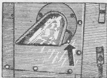
Rys. 4-159 Dźwignia przesłony ogrzewania
