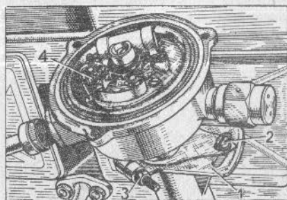
Rys. 4-50. Elementy regulacji rozdzielacza zapłonu
