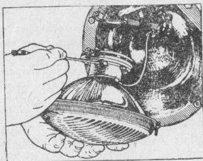
Rys. 4-150. Odkręcanie śrub mocujących oprawkę z żarówkami
