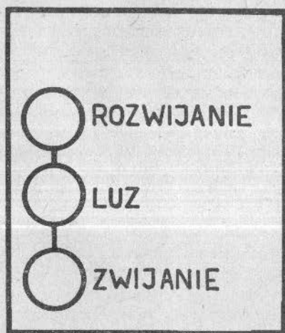
Rys. 3-5. Schemat położenia dźwigni przy- stawki odbioru mocy
